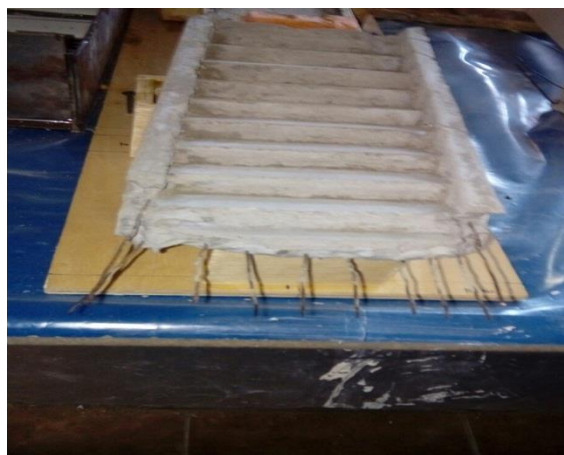
Сурет 3 - Баспалдақ маршының ең алғашқы кішірейтілген үлгісі.
