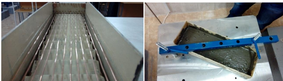
Сурет 4 - Баспалдақ маршының болат формада жасалынған 2-ші үлгісі
