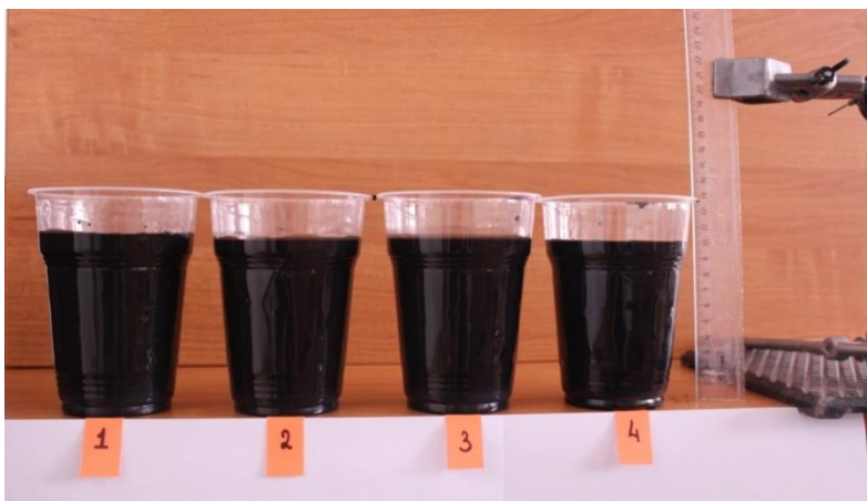
Сурет 5 – 10 тәулік бойына тұрақтылыққа ие, электроимпульстік және ультрадыбыстық өңдеуден кейін алынған, сулы-көмірлі отынның фототүсірілімі
