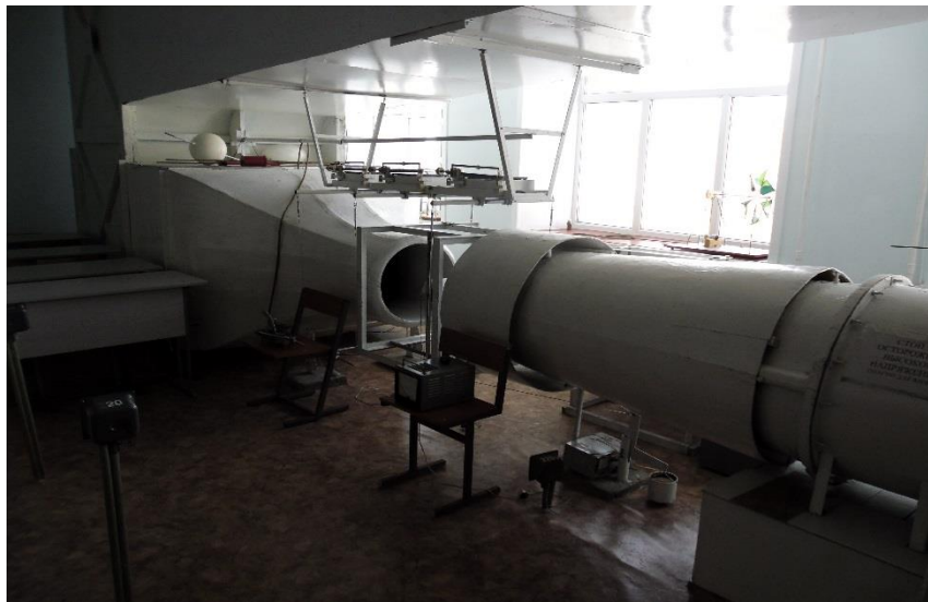
1 сурет – Т -1-М Аэродинамикалық қондырғының бейне суреті
