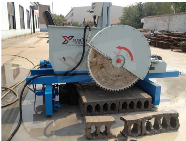
2 сурет - Бұйымдарды кесетін машина
