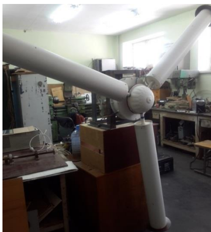
1 сурет - Айналымы цилиндрлер түріндегі қалақшалы желгенераторының тәжірибелі үлгісі
