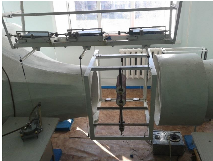
2 сурет – Кедір-бұдыр бетті цилиндрлер бекітілген аэродинамикалық құбырдың жұмыстық бөлігінің бейне суреті
